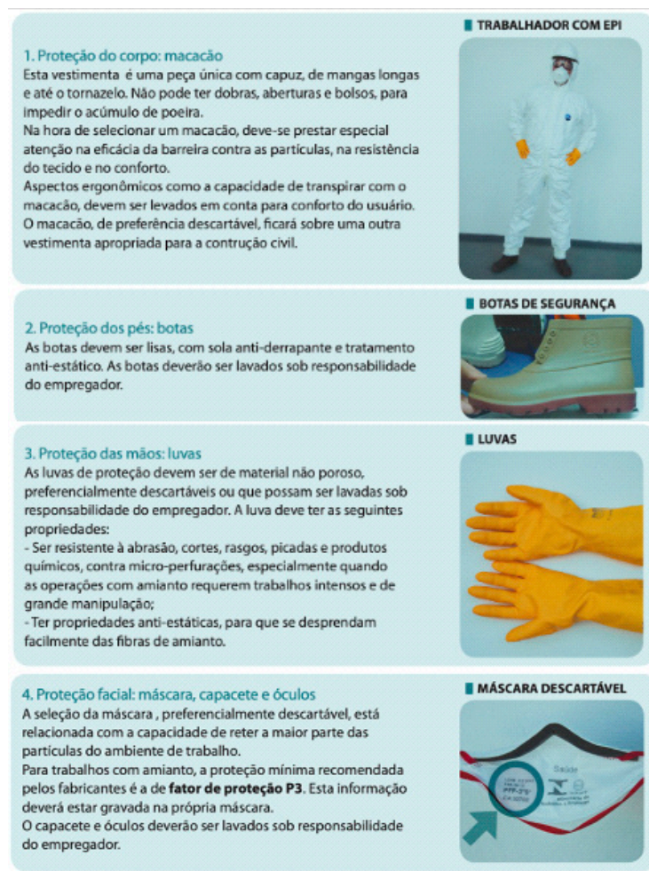
Figura 2 – Exemplos de EPIs utilizados em trabalhos com FCA (Fundacentro, 2022)
