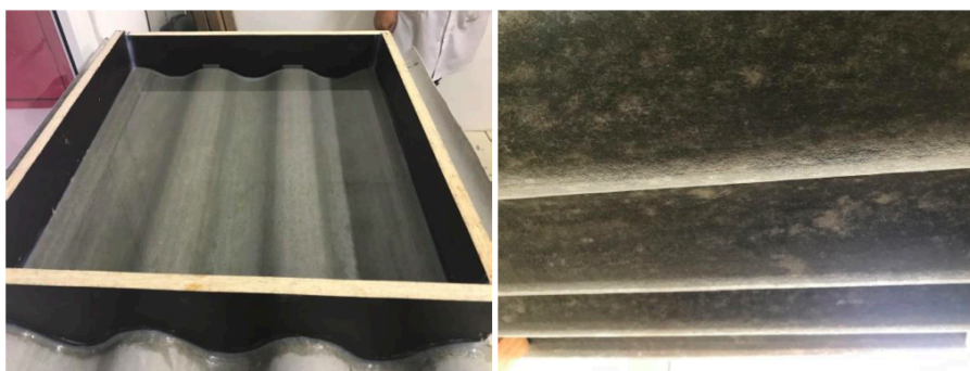
Figura 1. – Teste de permeabilidade, telha sem formação de gotas.
